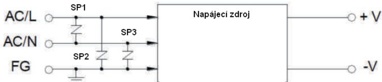
Obr. 4: Ochrana před přepětím na vstupu zdroje pro zvýšení spolehlivost napájecí části - prvky SP1~3 (surge protection) MEAN WELL SPD-20
